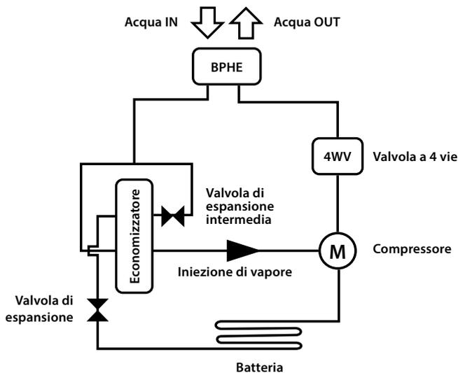
Ciclo del refrigerante con iniezione di vapore
