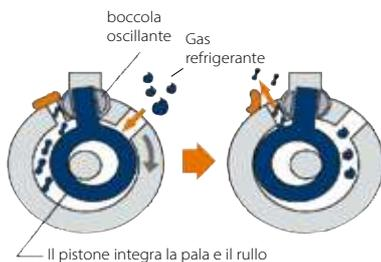
I mini refrigeratori serie EWA(Y)A-DV3P(DW1P) sono dotati di compressore Swing con Inverter. Questo design innovativo di Daikin con meno parti mobili consente un funzionamento più regolare e affidabile con meno vibrazioni e livelli di rumorosità ridotti. Il motore a elevata efficienza riduce i consumi energetici e consente di risparmiare sui costi.
