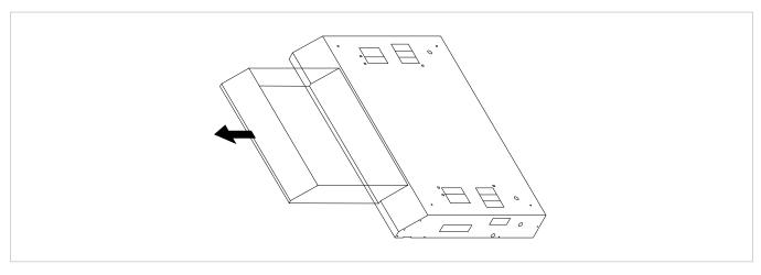
▲ Se il ventilconvettore installato nella struttura metallica viene utilizzato per il raffrescamento dei locali, lo spessore del cartongesso dovrà essere mantenuto completamente al di sotto
