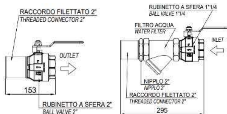
Figura 14 – Elementi del circuito idraulico
