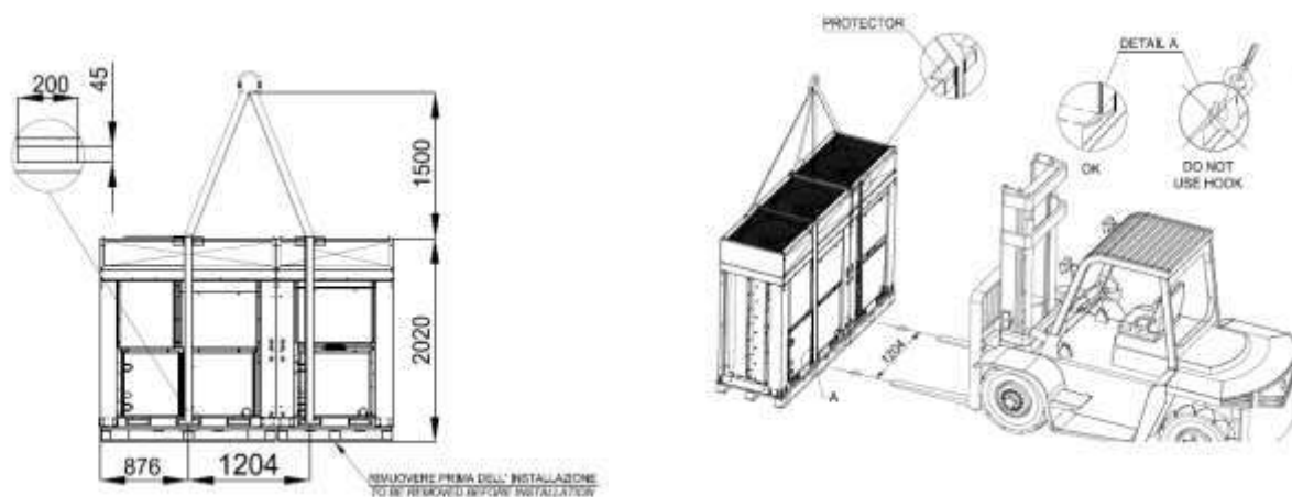
Figura 2 – Sollevamento dell'unità DUAL esterna
